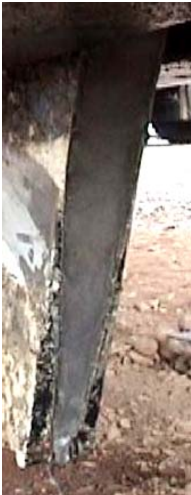
L'emplacement où était soudé l'aileron. L'aluminium est comme neuf.
